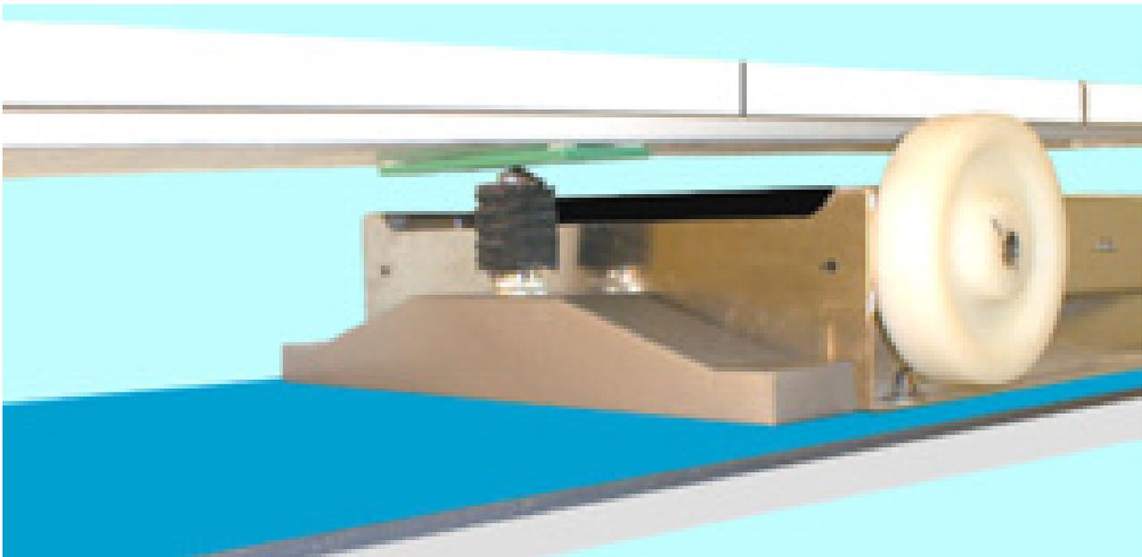
Der Dämpfer ist ein Öldruckdämpfer, der in einer speziellen, massiven und wetterbeständigen Halterung, hinter dem Walzenverstellkasten (zwischen Endlager und Walzenverstellkasten) montiert wird. Er fängt das Sprungbrett ab, bevor das Brett auf die Walze schlägt. Unterhalb des Sprungbretts muß eine Verstärkungsplatte angebracht werden, damit der Dämpferkopf an dem Sprungbrett keinen Schaden anrichten kann.
