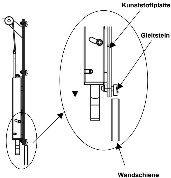
Abb.4: Montage der Spannvorrichtung an der Wand Schiene
