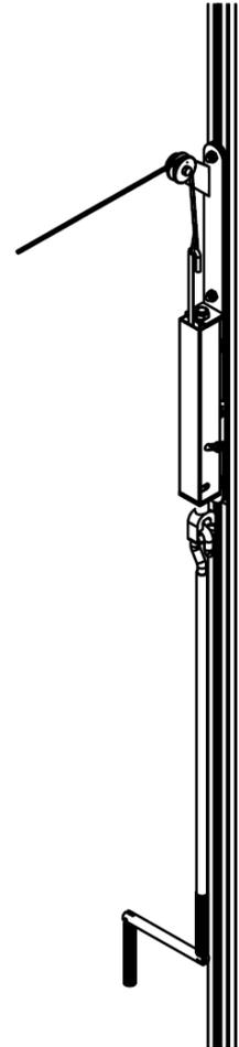
Abb.3: Spannvorrichtung mit Kurbel an einer Wandschiene
