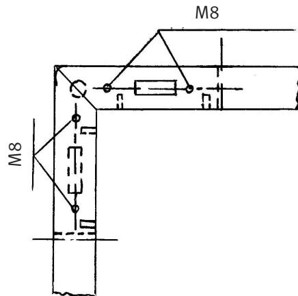
2. Oberen Netzbügel-Haltewinkel auf Latte-/Pfostenkonstruktion legen (so dass die Bohrlöcher des Winkels über denen der Latte-/ Pfostenkonstruktion liegen) und mit jeweils 4 Stück Sicherheits-Sechskantschrauben M 8x50 befestigen.
