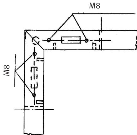
2. Poser l'angle de fixation de l'étrier sur la construction barre/poteaux (il faut que les forures de l'angle soient au-dessus des forures de la construction barre/poteaux) et fixer avec 4 vis à six pans creux M 8x50 chaque.
