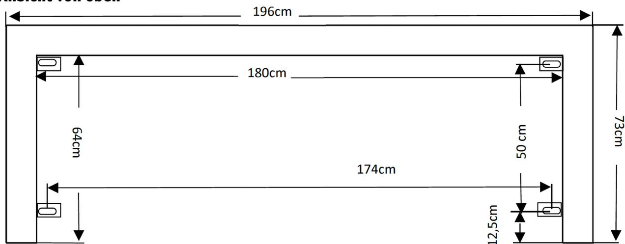
Zur Befestigung der Tore empfehlen wir 2 Fundamente 800 x 400 mm und 800 mm tief.
