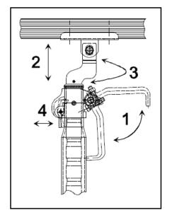
Barreneinschub mit den Holmen langsam in die Standrohre einschieben (2) und den Klemmverschluss wieder schließen (1).
