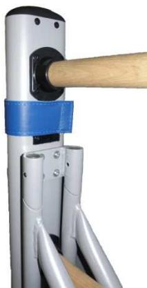
**Abbildung 4: Befestigungsband lösen**
