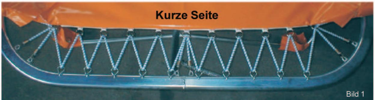
Spannkabel, ca. 9 mm Ø mit Spiralhaken an den Enden. Montage im "Zick-Zack", wie im Bild zu erkennen. Beginnend jeweils mit der kurzen Seite. Weiter an den beiden Längsseiten, dabei jeweils zuerst das mittlere Spannkabel einspannen, immer auf gleichmäßige Spannung achten.
