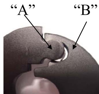
Per accoppiare le due semiflangie, appoggiarle sull'asta tenendole inclinate in modo che la protuberanza "A" si trovi davanti all'incavo "B" quindi portarle in verticale esercitando una leggera pressione.
