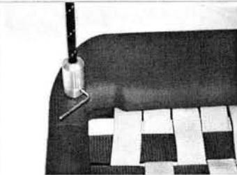
Die Seilverschraubungen an den Ecken festdrehen und mittels Madenschraube (schwarz) und kleinem Sechskant-Stiftschlüssel sichern.
