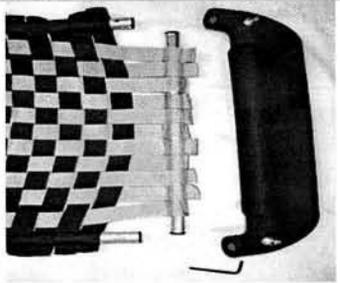
Anschließend alle langen Bänder auf das 2. kurze Rohr (Teil B) auffädeln.
