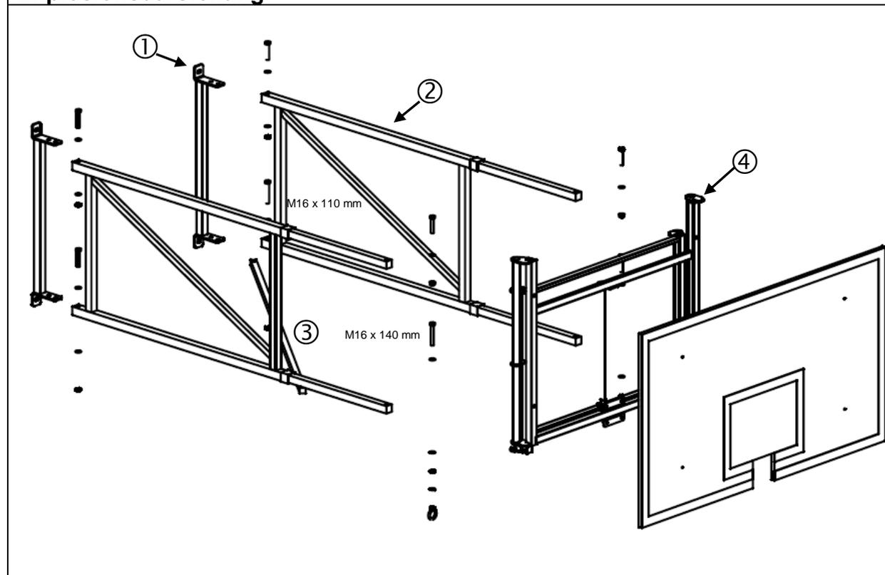
Zur Montage des Basketball-Wandgerüsts sollte wie folgt vorgegangen werden. Befestigen Sie zuerst die Wandriegel ① an der dafür vorgesehenen Wand. Achten Sie darauf, dass der richtige Wandriegel für den richtigen Untergrund verwendet wird. Der Untergrund muss so gewählt werden, dass er Lasten nach DIN 18032-6 und DIN 7899 aufnehmen kann
