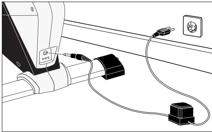
**D** Bei Geräten mit Netzteil: **Achtung!** Betrieb nur mit mitgeliefertem Original-Netzteil oder Original-KETTLER-Ersatzteil (siehe Ersatzteilliste) zulässig. **Ansonsten Gefahr der Beschädigung.**
