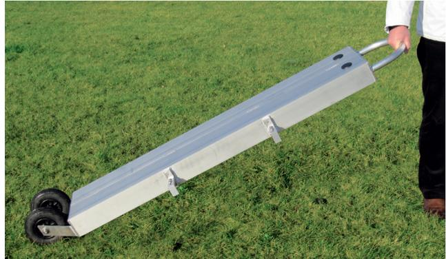
2. Die im Zubehör befindlichen 4 Stück vormontierten Sicherungsbügel mit Maschinenschrauben M8 x 25 und Unterlegscheiben Ø 8,4mm, an den Zusatzgewichten befestigen (siehe Foto), je Gewicht 2 Stück. Abhängig von der Höhe des Bodenrahmens können die jeweils oberen oder unteren Befestigungsbohrungen an den Gewichten verwendet werden.
