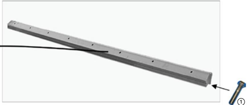
1. Legen Sie das Beschwerungsprofil an den Bodenrahmen Ihres Tores – mit der an Ihr Bodenrahmenprofil passenden Seite der Nut. Schieben Sie die 5 Maschinenschrauben ① in die Profilvernut.
