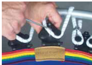
Erhöhen der Spannung durch Veränderung der Kabelführung von Position 2 zu Position 3.
