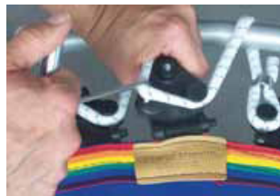
Erhöhen der Spannung durch Veränderung der Kabelführung von Position 2 zu Position 3.
