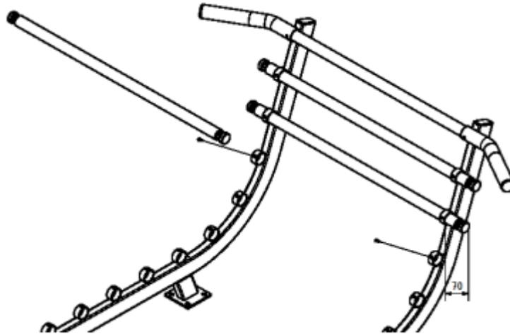
Abb. 3: Zusammenbau der Sprossenwand "X"
