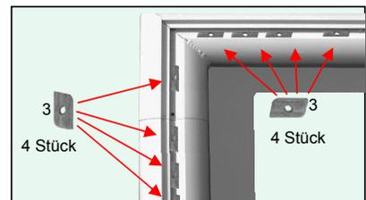
3. Schlagen Sie die Einschlagklappen<sup>4</sup> mit einem Holz- oder Gummihammer in die Streben<sup>St</sup> an den Netzbügeln<sup>NB</sup> – rechte und linke Seite beachten! – mit den Innensechskant-Schraube<sup>5</sup> und selbstsichernden Muttern<sup>6</sup>.
