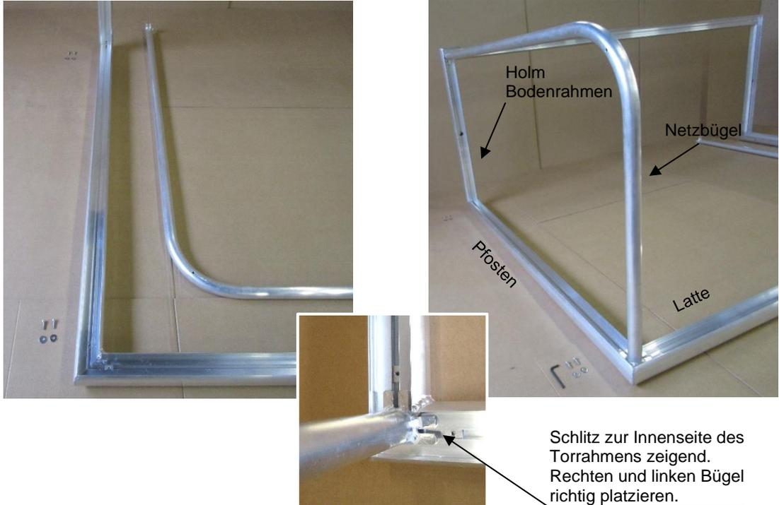
Befestigung Netzbügel oben: Im Eckbereich Latte/Pfosten die werkseitig und zuvor bei der Montage im Pfosten eingeschobenen Einsteckmuttern unter die geschlitzte Platte des Netzbügel schieben (siehe Foto unten links).
