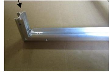
Die offenen Enden des Bodenrahmens an beiden Seiten auf die Eckverbinder stecken und jeweils 2 Stck. Sicherungs-Senkschrauben DIN 7991, M8 x 16 seitlich einschrauben (siehe Foto unten rechts). Die Ecke ausrichten und alle Schrauben fest anziehen.
