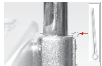
Abb. 5: Splint vor und nach dem Entfernen vom Trapezstisch.
