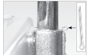
Figure 5 : Goupille fendue avant et après le retrait de la table Trap
