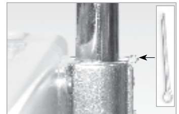
Figura 5: Pasador de chaveta antes y después de retirarlo de la mesa de trapecio.
