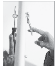
Figura 9: Usare due dita per stringere i bulloni
