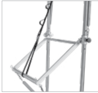
图6: 安全带使推杆保持在4点钟位置。安全带固定于PTB和顶棚架, 而非吊环螺栓。
