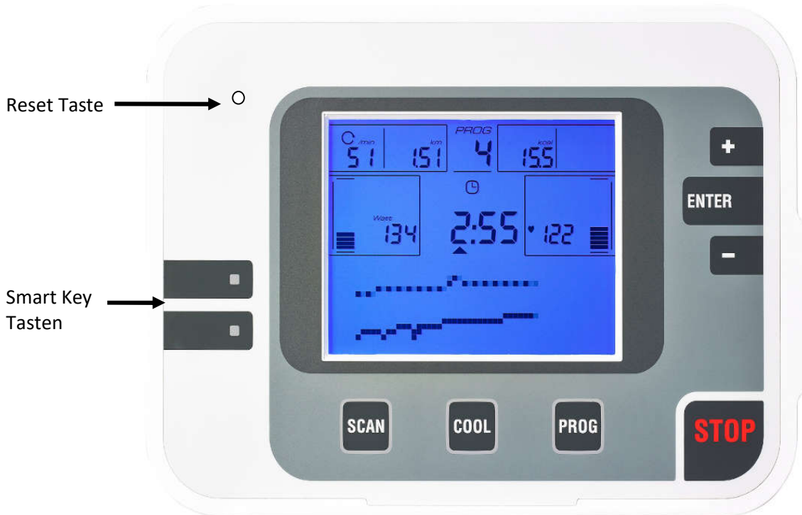
Abbildung 2: Monitoransicht frontal, zur Erklärung der Tastenfunktionen
