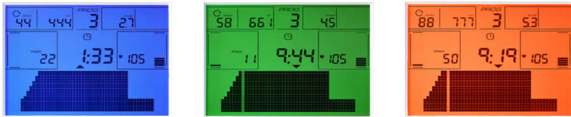
Abb.4: Multicolor-Hintergrundbeleuchtung als Biofeedback zur Indikation der Zieleinhaltung.
