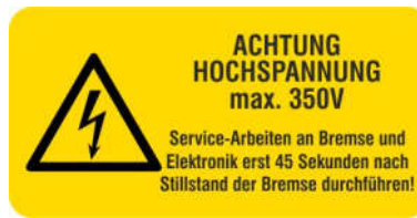
Abb.6: Warnhinweis an Bremse wegen Gefahr durch Hochspannung.
