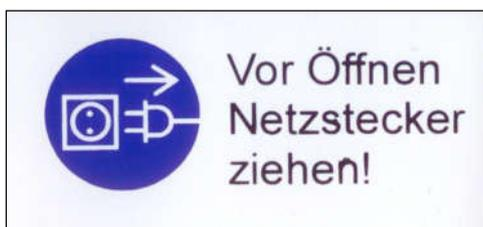
Der Hinweis „Vor Öffnen Netzstecker ziehen“, soll bei Montage oder Wartungsarbeiten, dem Servicepersonal den Hinweis geben, das Gerät stromlos zu machen, damit keine stromführenden Bauteile berührt werden, und kein Stromschlag für das Servicepersonal entstehen kann.
