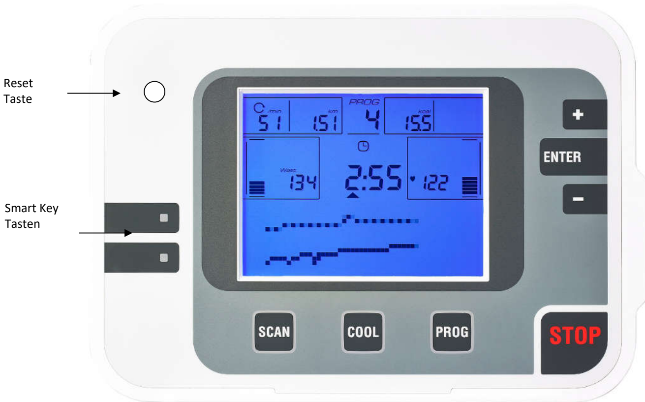
Abbildung 2: Monitoransicht frontal, zur Erklärung der Tastenfunktionen
