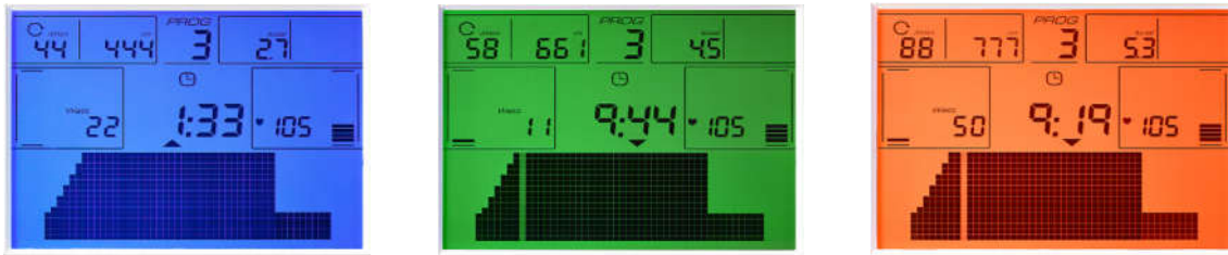
Abb.4: Multicolor-Hintergrundbeleuchtung als Biofeedback zur Indikation der Zieleinhaltung.
