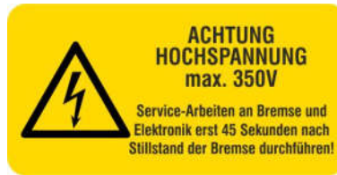
Abb.6: Warnhinweis an Bremse wegen Gefahr durch Hochspannung.
