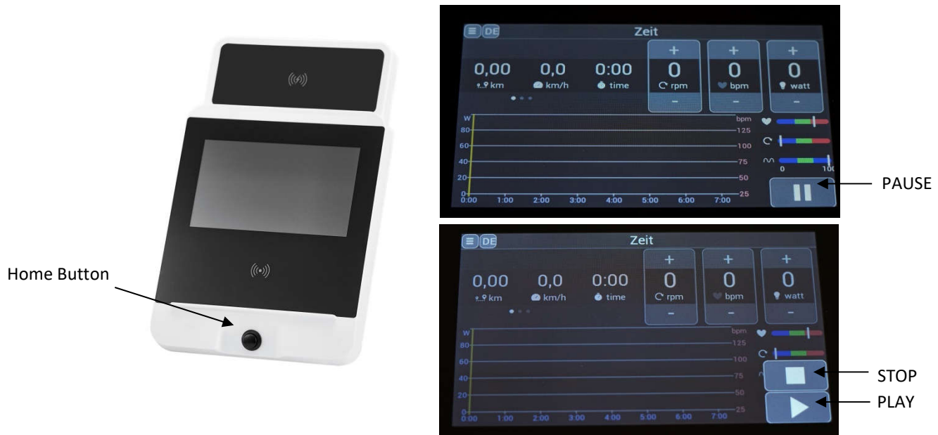
Abb. 2: Monitoransicht, zur Erklärung der Tastenfunktionen, tatsächliche Ansicht kann farblich variieren, Tastenbelegung ist gleich.
