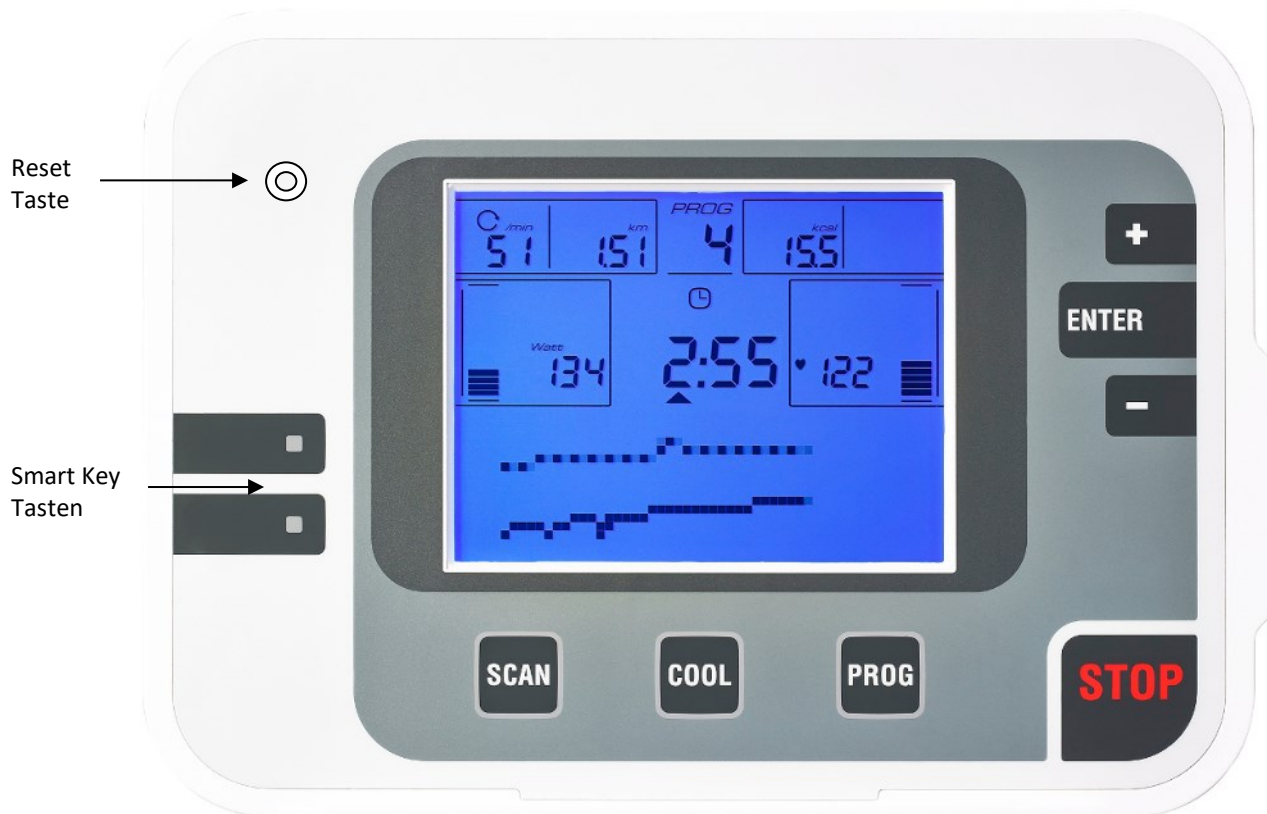
Abbildung 2: Monitoransicht frontal, zur Erklärung der Tastenfunktionen
