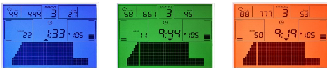
Abb.4: Multicolor-Hintergrundbeleuchtung als Biofeedback zur Indikation der Zieleinhaltung.
