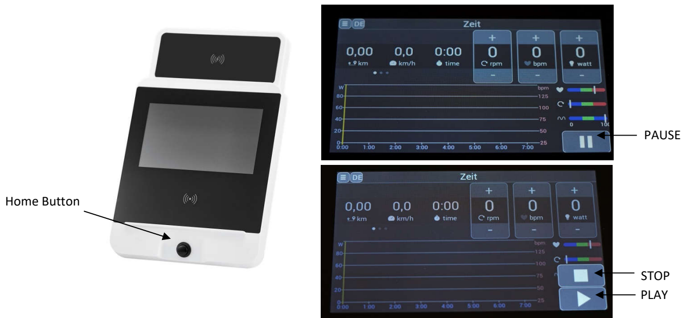
Abb. 9: Monitoransicht, zur Erklärung der Tastenfunktionen, tatsächliche Ansicht kann farblich variieren, Tastenbelegung ist gleich.
