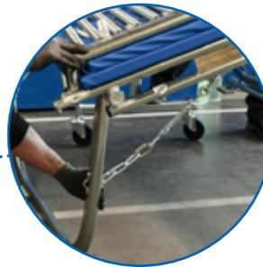
Die Ketten des mittleren Fußes muss gespannt sein.
