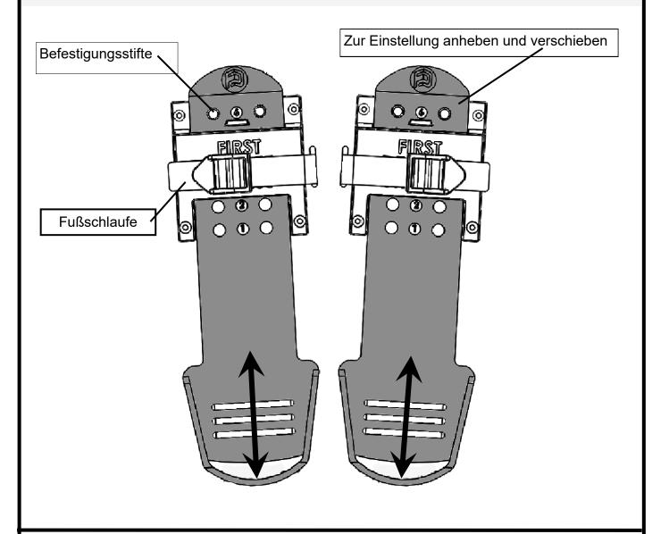
Die Gleitfußplatte ist für unterschiedlichste Fußgrößen ausgelegt und sehr einfach zu verwenden.
