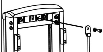
Ist das Bungeeseil an der Stützstrebe befestigt, ziehen Sie die Bolzen zur Befestigung des Trittbretts und des Hauptrahmens an den Seitenschienen fest an, da sie in vertikaler Position leichter erreichbar sind.
