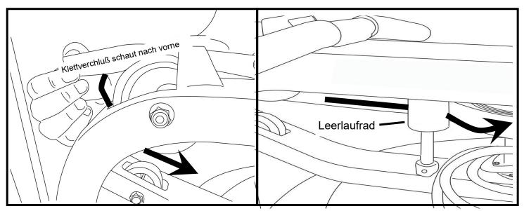
2. Als nächstes fädeln sie den Gurt um das Leerlaufrad. Sobald der Grut um das Leerlauf-rad geführt ist befestigen sie ihn am Gurt und Seilrad. Die korrekte Stelle ist mittels eines klar sichtbaren Rand gekennzeichnet.
