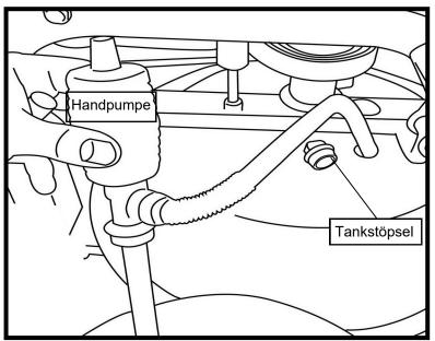
Hinweis: Es werden 17 Liter Wasser benötigt um eine maximale Befüllung zu gewährleisten
