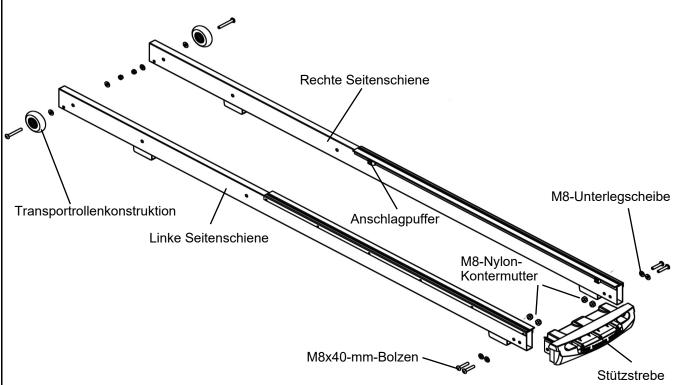
Tipp: Die Anschlagpuffer sind richtig ausgerichtet, wenn sie an der Innenseite der Schienen montiert werden.
