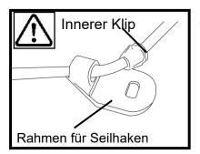
Nehmen sie den Haken aus der Halterung am hinteren Fuß und drücken sie den inneren Klip nach unten. Drücken sie das Seil durch den Klip bis es frei wird. Dadurch wird ermöglicht, dass das Seil komplett aus dem Hauptrahmen und dem Gurtrad ausgeführt wird und sich somit spatter wieder richtig dort anbringen läßt, sobald der Rudergurt wieder in der richtigen Position ist.
