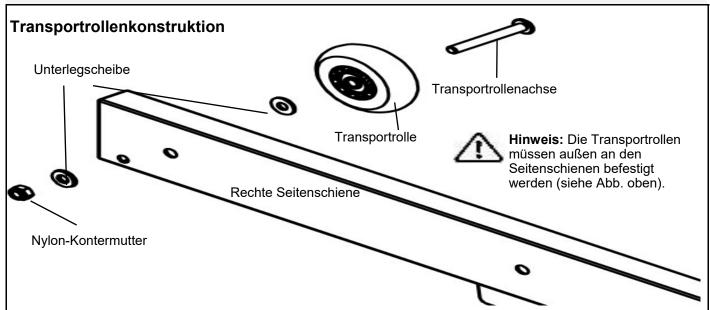
Sobald die Stützstrebe und die Seitenschienen montiert sind, können Sie die Transportrollenkonstruktion an der linken/rechten Seitenschiene befestigen.
