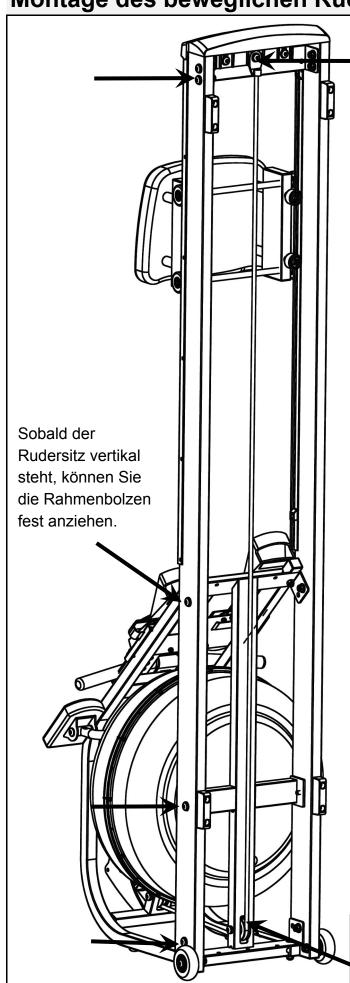
M8x20-mm-Bolzen [8], M8-Unterlegscheiben [6] werden an der Stützstrebe [4] angebracht.
