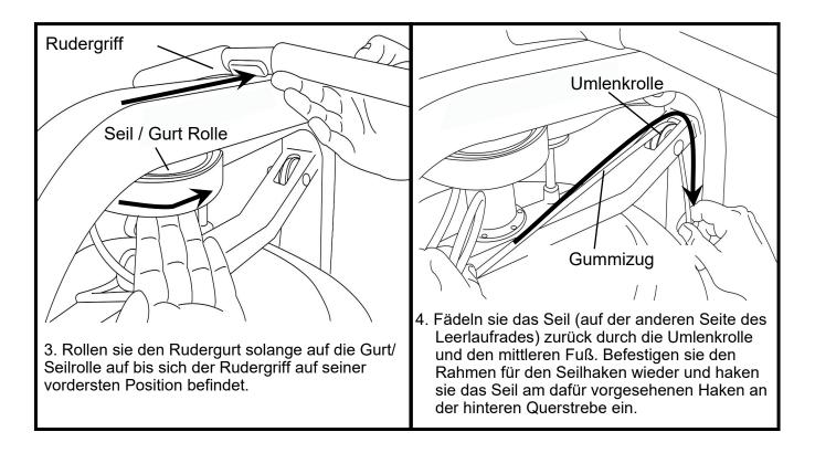
Die Rückzugstärke kann sehr einfach an die individuellen Bedürfnisse eingestellt werden. Um Einstellungen vorzunehmen schieben sie einfach den inneren Klip nach unten aus dem Rahmen für den Seilhaken und ziehen sie die gewünschte Länge an Seil durch und fixieren sie den Rahmen mit dem Klip wieder am Seil.
