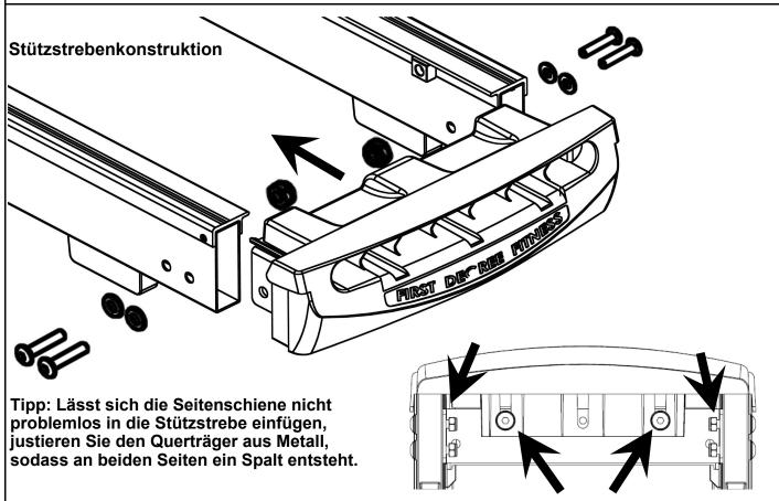
Hinweis: Ziehen Sie nach dem Anbringen der Schienenbolzen die Bolzen an der Stützstrebe fest an.
