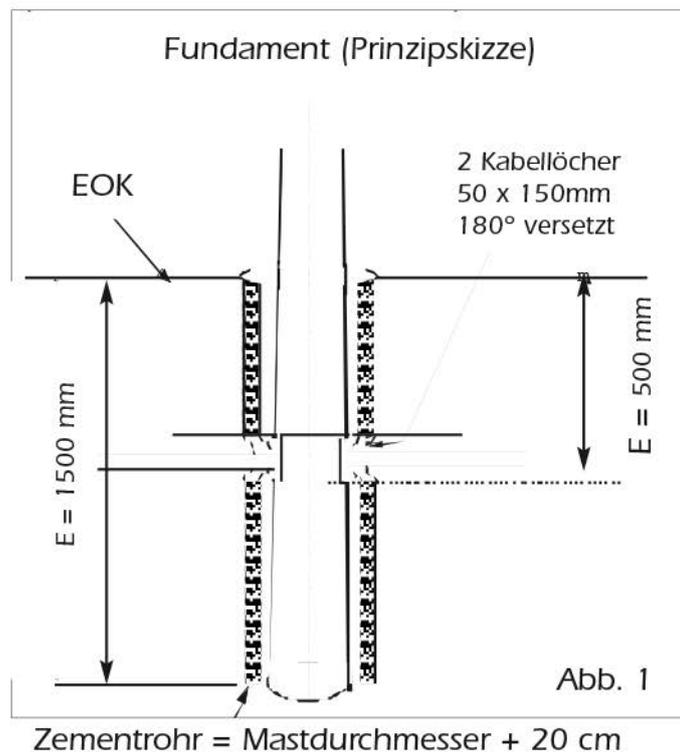
**ACHTUNG :** Nach den Fundamentierungsarbeiten sollte vor der Montage der Maste eine Frist von 28 Tagen zum Abbinden des Betons vorgesehen werden. Zur Ermöglichung des Kondenswasserabflusses sollte auf jeden Fall eine entsprechende Drainage eingeplant werden.
