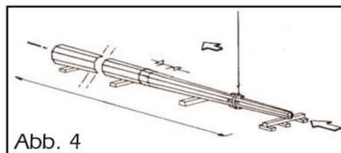
Ziehen Sie die beiden Schüsse so weit wie möglich per Hand zusammen, arbeiten Sie anschließend mit dem Vorschlaghammer. Legen Sie zum Schutz einen Holzklötz zwischen Hammer und Zopf des Aufsatzes) (Abb. 5).
