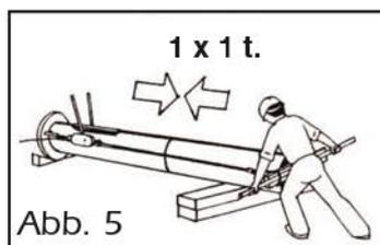
Bitte überprüfen Sie, ob die tatsächliche Überlappungslänge mit den theoretischen Werten übereinstimmt. Sollte dies nicht der Fall sein, ist mit dem Zusammenziehen fortzufahren, bis die ermittelten Mindestwerte erreicht sind (überschreiten Sie ggf. den theoretischen Wert, bis eine optimale Überlappung erreicht ist):
