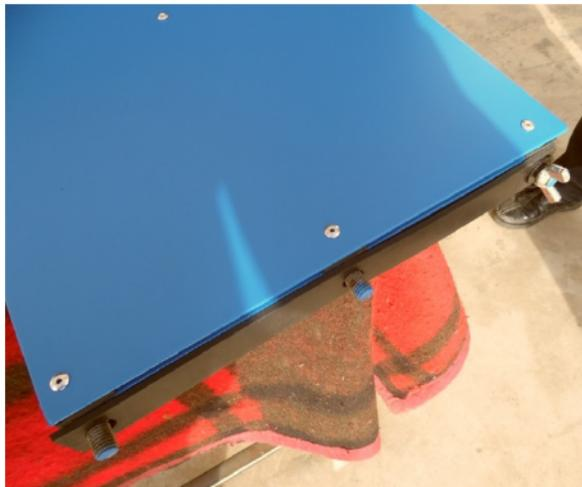
Entfernen Sie vor dem Einsetzen der Stahlplatte zwischen den beiden Toren die Flügelschrauben und die Unterlegscheiben (drei auf jeder Seite der Platte).
