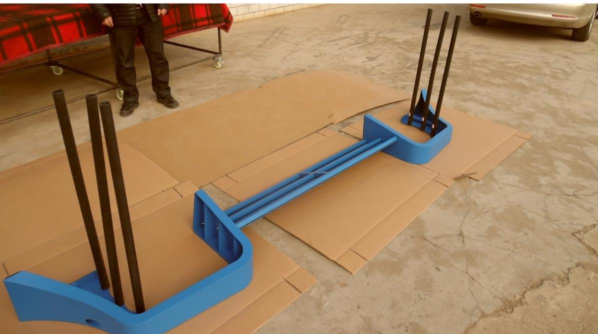
Es gibt drei Aluminiumstützen, eine hintere Stütze (die größte) und zwei seitliche. Stecken Sie die seitlichen Stützen wie im Bild gezeigt auf die Rohre, eine Stütze links und eine rechts.
