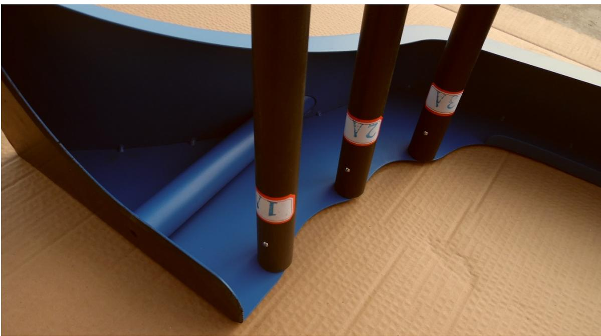
Nehmen Sie nun die Rohre 1D, 2D und 3D und stecken Sie sie auf die entsprechende Position am linken Tor.
