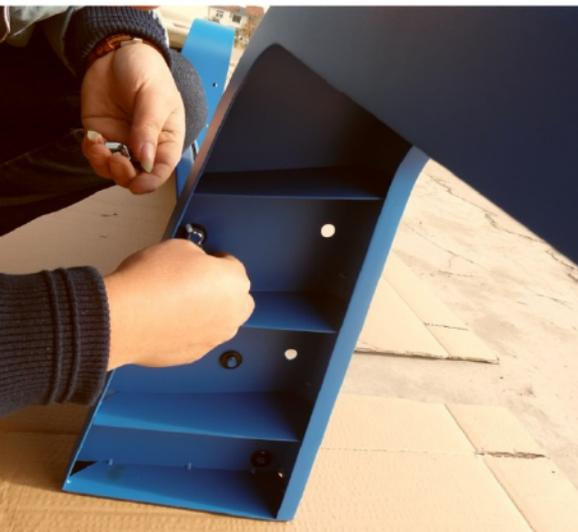
Legen Sie die Unterlegscheiben auf die Schrauben. Ziehen Sie dann die Flügelschrauben auf der Innenseite des linken und rechten Tors fest. Jeweils drei in beiden Toren.
