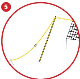
**5** Lege die Schlaufen der Spanngurte um die oberen Enden der Netzpfosten und stelle diese zum Netz hin schräg auf. Lege auch die Schlaufen des oberen Spannseils des Netzes über die Enden der Pfosten.
