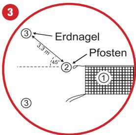
**3** Die Positionen der Erdnägel werden folgendermaßen festgelegt: Entfalte dazu vollständig das Netz **1**. Die Enden bzw. die Schlaufen des oberen Spannseils markieren die Positionen der Netzpfosten **2**. Von hier aus werden die Erdnägel jeweils in einem 45°-Winkel in einer Entfernung von ca. 3,3 m platziert **3**. Du kannst dich auch an Abbildung 7 orientieren.
