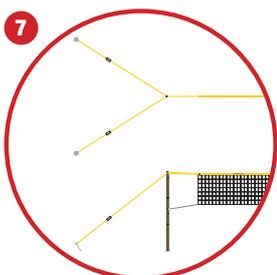
**7** Die optimale Netzposition wird durch Nachjustieren der Spanngurte und der unteren Spannleinen eingestellt. Das Netz sollte genau in der Flucht der Netzpfosten hängen.
