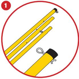
**1** Beide Netzpfosten setzen sich aus je drei Rohrteilen zusammen. Das Rohr mit der schwarzen Kunststoffkappe ist das Oberteil. Du kannst mit Hilfe der Löcher zwischen zwei Netzhöhen wählen. Befestige dazu eine der Metallösen an der gewünschten oberen Position. Eine zweite Metallöse platzierst du in entsprechendem Abstand (ca. 1,1 m) darunter.
