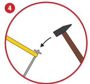
**4** Insgesamt erhältst du so vier Verankerungspunkte für die Erdnägel. Diese werden mit einem Hammer in einem Winkel (vom Pfosten weg) in den Sand geschlagen. Achte darauf, dass du vorher die Schlaufen der Spanngurte um die Erdnägelköpfe gelegt hast.
