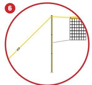
**6** Spanne alle vier Spanngurte gleichmäßig ab und stelle die Netzpfosten dabei senkrecht. Um das Netz zwischen den Pfosten zu zentrieren nutze die dünneren gelben Spannleinen, indem du sie jeweils an einer Schrauböse oben am Pfosten befestigt. Verbinde die untere weiße Spannleine mit der unteren Schrauböse und befestige sie mit der gewünschten Spannung.
