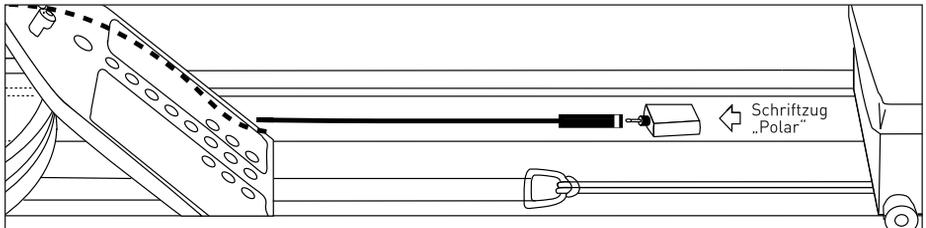
**Wichtig:** Der Empfänger muss mit der schmalen, langen Seite an der Schiene angebracht werden, damit ein optimaler Empfang gewährleistet werden kann.
