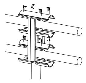
**3.** Richten Sie die Holzstangen so aus, dass sie auf beiden Seiten ca. 20 bis 30 cm über der Halterung hinausragen.
