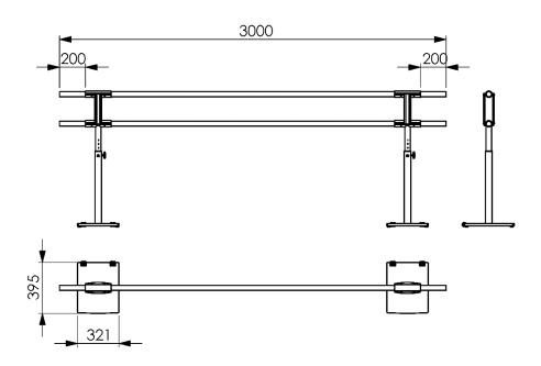
**4.** Platzieren Sie jetzt die beiden Befestigungsplatten passend um die Holzstange, sodass Sie beide Elemente wieder fest zusammenschrauben können (Inbusschlüssel).
