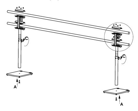
2. Entfernen Sie die oberen und unteren Schrauben der Befestigungsplatten.
