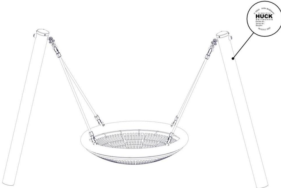
Plakette nach der Montage bzw. dem Lackieren von außen sichtbar an den Pfosten anbringen. (Untergrund fettfrei säubern)
