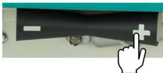
Figur 25. Einstellung des Mittelteils. Mittelteilsteuerung.
