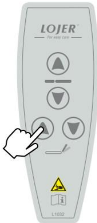
Figur 27. Einstellung des Rückenteils. Handsteuergerät.
