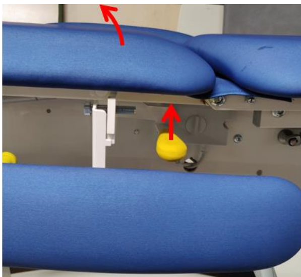
Figura 26. Regolazione della sezione centrale. Molla a gas.
