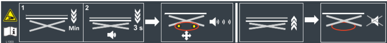
Schéma 1. Mise en place de la table sur ses roulettes et retrait de la table de ses roulettes
