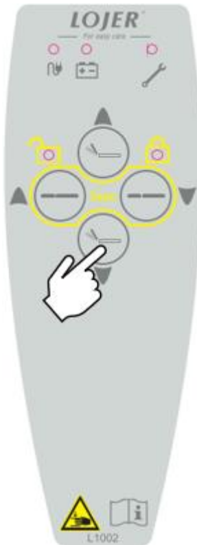
Schéma 26. Réglage du dossier. Commande manuelle.
