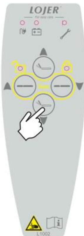
Figura 26. Regolazione dello schienale. Comando manuale.
