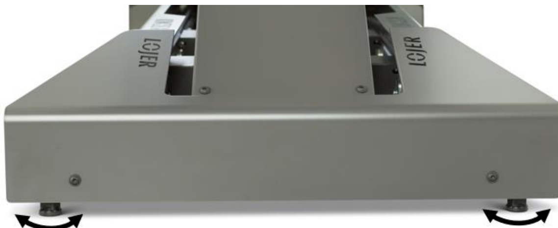
Schéma 9. Ajustement des patins de réglage permettant de stabiliser la table sur un sol irrégulier
