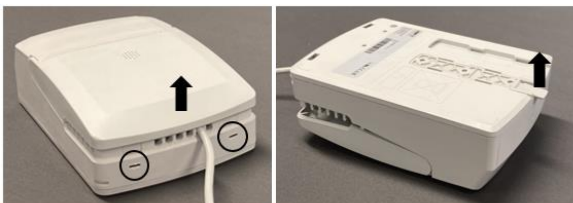
Figura 34. Sostituzione della batteria
