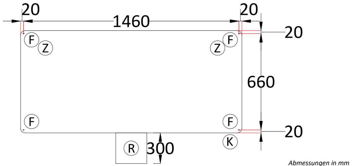
(Z): Befestigungsloch, vorgesehen für die Wartung (Aufbau/Abbau der Frontseite).
