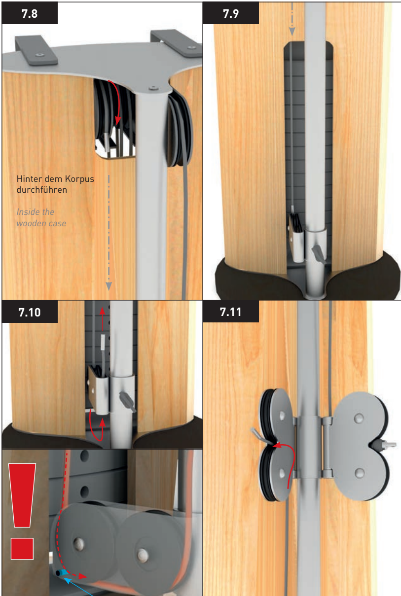
Kabel zwischen Sicherungsstift und Rolle durch führen. Make sure to carefully feed the cable between the bolt and pulley.
