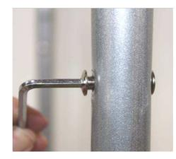
Nun wird jede Rohrverbindung mit einem durchgehenden Gewindestab mit aufgeschraubten Hülsenmuttern fest verbunden. Beim Anziehen der Schraube mit dem zweiten Innensechskantschlüssel gegenhalten.
