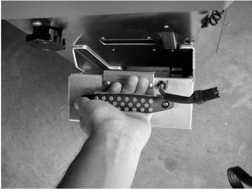
2. Richten Sie die SchlieÙe an der Einführöffnung aus, während Sie die Laschen an der Unterseite ausrichten, und schieben Sie den Akku nach unten bis er einrastet
