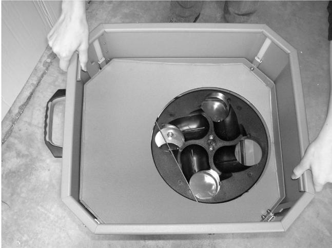
2. Ziehen Sie den Behälter nach oben, während Sie die Entriegelungshebel des Behälters weiter drücken.
