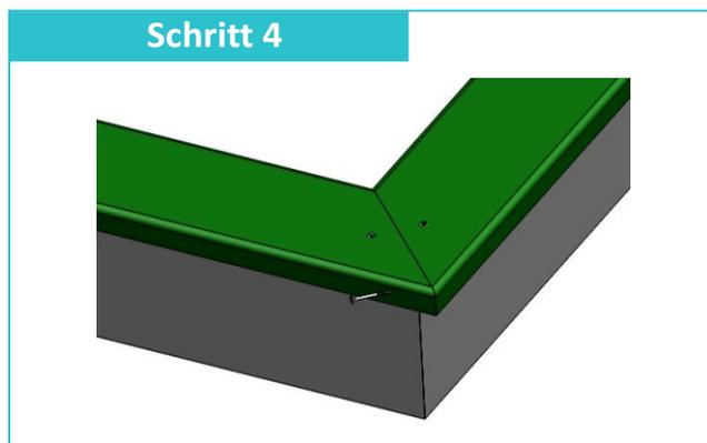
An jeder Ecke wird zusätzlich noch eine Schraube (6x80 mm) eingedreht. Achten Sie bei der Montage der Sitzauflagen darauf, dass die abgerundeten Kanten nach oben zeigen. Befüllen Sie den Sandkasten nun mit Sand und er ist spielbereit.
