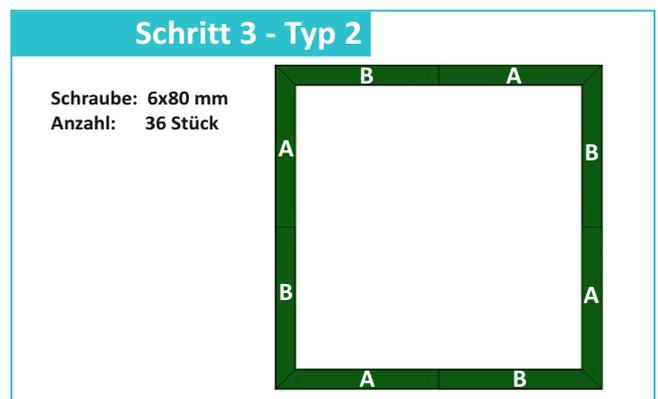
Legen Sie alle Sitzauflagen entsprechen der Skizze auf die Seitenteile auf. Verschrauben Sie die Sitzauflagen mit den Seitenteilen von oben mit je 4 Schrauben (6x80 mm) pro Sitzauflage.
