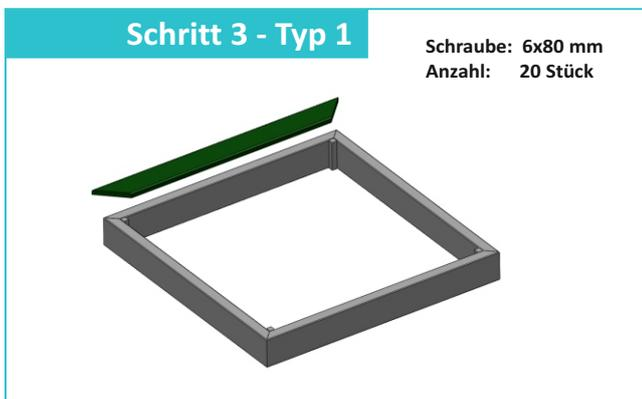
Legen Sie alle Sitzauflagen auf die Seitenteile auf. Verschrauben Sie die Sitzauflagen mit den Seitenteilen von oben mit je 4 Schrauben (6x80 mm) pro Sitzauflage.
