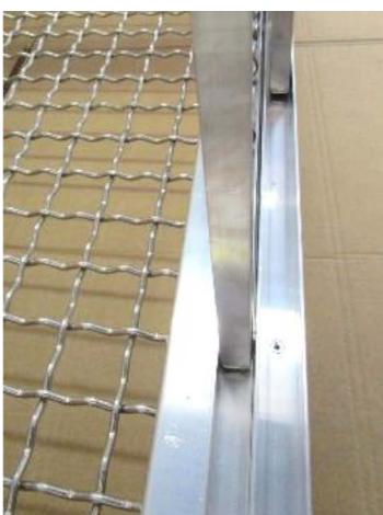
Führungsschiene Schiebtür im Unterteil
