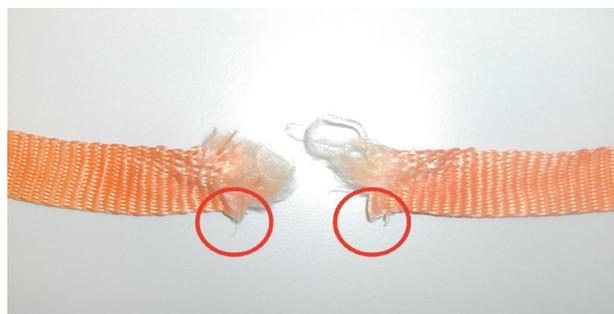
Schnitt in der Line führt zum Bruch des Bandes.
