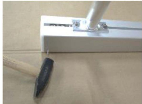
Im nächsten Montageschritt das Bodenrohr mit der Nut nach oben auf den Boden legen. Nun an beiden Seiten des Bodenrohres je 2 Stck. Einsteckmuttern 20mm, Gewinde M8 in die Nut einschieben und das Bodenrohr zwischen den Bodenholmen platzieren (siehe Foto unten links). Danach an jeder Seite des Bodenrohres 1 Stck. Z-Winkel auflegen und die Einsteckmuttern so verschieben, dass die Bohrungen von Z-Winkel und Einsteckmuttern deckungsgleich sind.
