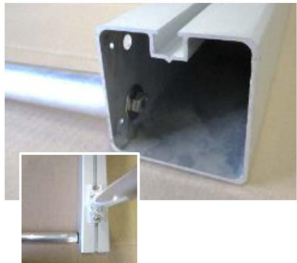
Nun die Verschlusskappen in die offenen Enden der Bodenholme stecken. Die Kunststoffstege der Verschlusskappen durch die werkseitig angebrachten Bohrungen in jedem Bodenholm mit einem 1,5 mm Bohrer aufbohren. Danach die Steckerstifte mit einem Hammer/Gummihammer eintreiben (siehe nachfolgende Fotos). Alle Schrauben am Netzbügel nochmals fest anziehen.
