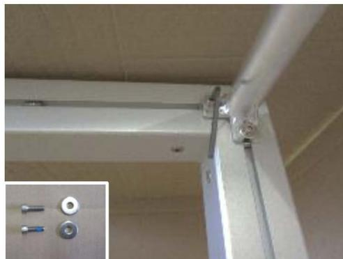
Im nächsten Montageschritt am offenen Ende jedes Bodenholms 2 Stck. Einsteckmuttern 40 mm, Gewinde M6 in die Nut einschieben. Dann 4 Stck. Unterlegscheiben  $\varnothing$  7,4 mm, DIN 9021 auf 4 Stck. Sicherungs-Zylinderschrauben M6 x 20mm, DIN 912 stecken. Jeden Netzbügel mit 2 Stck. Sicherungs-Zylinderschrauben lose an den Einsteckmuttern befestigen (siehe Fotos unten).
