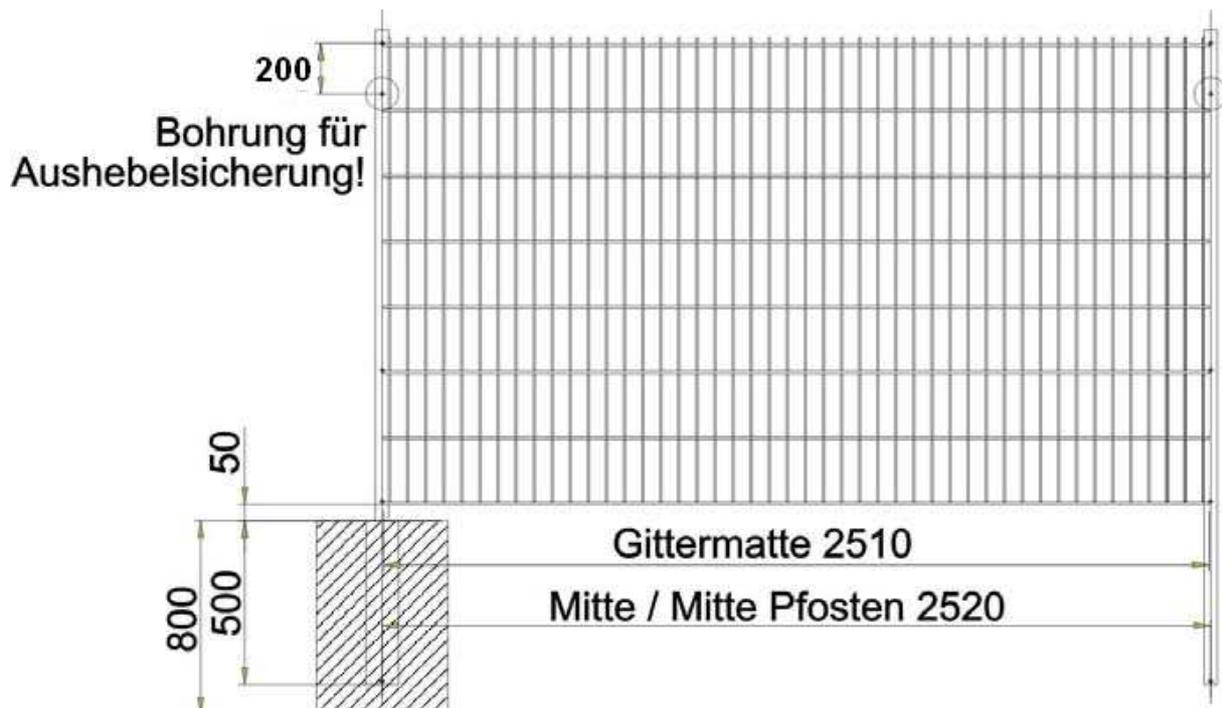
Wenn der Beton abgebunden hat (je nach Witterung bis zu 24 Std.) werden die Gitterelemente vor die Pfosten gelegt, um sie dann auf die Befestigungselemente zu hängen. Abschließend werden die Elemente mit der Abdeckleiste und den Schrauben am Pfosten verschraubt (**Typ I**) bzw. mit den VA-Klemmelementen und den Schrauben am Pfosten verschraubt (**Typ II**).
