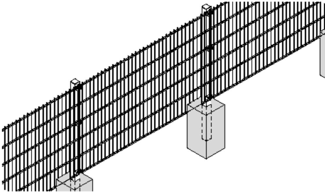
Die Befestigungen der Gitterelemente können wahlweise nach innen oder nach außen zeigen; innerhalb einer Zaunflucht jedoch sollte man **alle Pfosten gleich setzen**.
