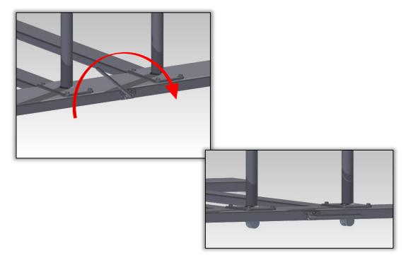
In diesem Zustand wird der Barren an seinen Einsatzort gefahren. Beim Transport des Barrens dürfen keine Personen oder zusätzliche Gewichte auf dem Barren mitfahren. Das Einklappen der Rollen funktioniert in entgegengesetzter Richtung
