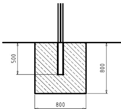
**Abbildung 2:** Anlage mit Fundament
