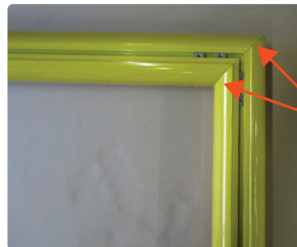
Gehrungen der Ecken dicht aneinander schieben
