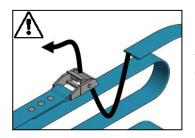
Achten Sie darauf, das lange Gurtband wie in der Abbildung dargestellt in das Klemmschloss einzufädeln, da sonst keine ausreichende Klemmwirkung erzeugt werden kann.
