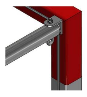
10. Den Torrahmen (1) aufstellen und die <u>oberen</u> Überschubsrohre (3) mit der Ringschraube M10x80 (12) und Sechskantmutter M10 (15) an das Tor verschrauben.
