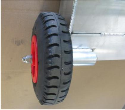
3. Stecken Sie jetzt das Rad auf das Alu-Rundrohr und dann eine weitere Unterscheibe DIN 125, Ø 13mm, auf die Schraube. Nun schrauben Sie die selbstsichernde Hutmutter DIN 986, M12 auf die Schraube und ziehen diese fest an.
